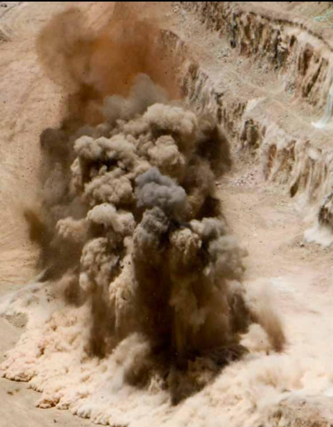
La tronadura es la fragmentación instantánea que se produce en la roca por efecto de la detonación de explosivos depositados en su interior. Es la primera etapa del proceso de reducción de tamaño que se aplica a la roca, por lo que su resultado incidirá de modo relevante en el manejo de este material en los procesos posteriores (chancado por ejemplo), por lo que constituye una etapa crítica en la eficiencia y productividad de la faena minera.
