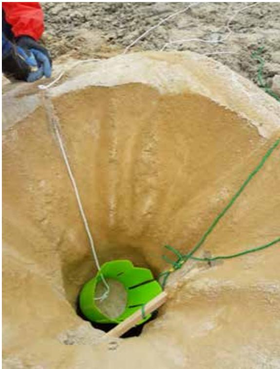
ESTA TÉCNICA PERMITE ELIMINAR O REDUCIR SUSTANCIALMENTE LA SOBRE-PERFORACIÓN, DISMINUYE LOS COSTOS E INCREMENTA LA DISPONIBILIDAD DE LOS EQUIPOS DE PERFORACIÓN; JUNTO CON REDUCIR LA PROYECCIÓN DE ROCAS Y LA GENERACIÓN DE POLVO.
